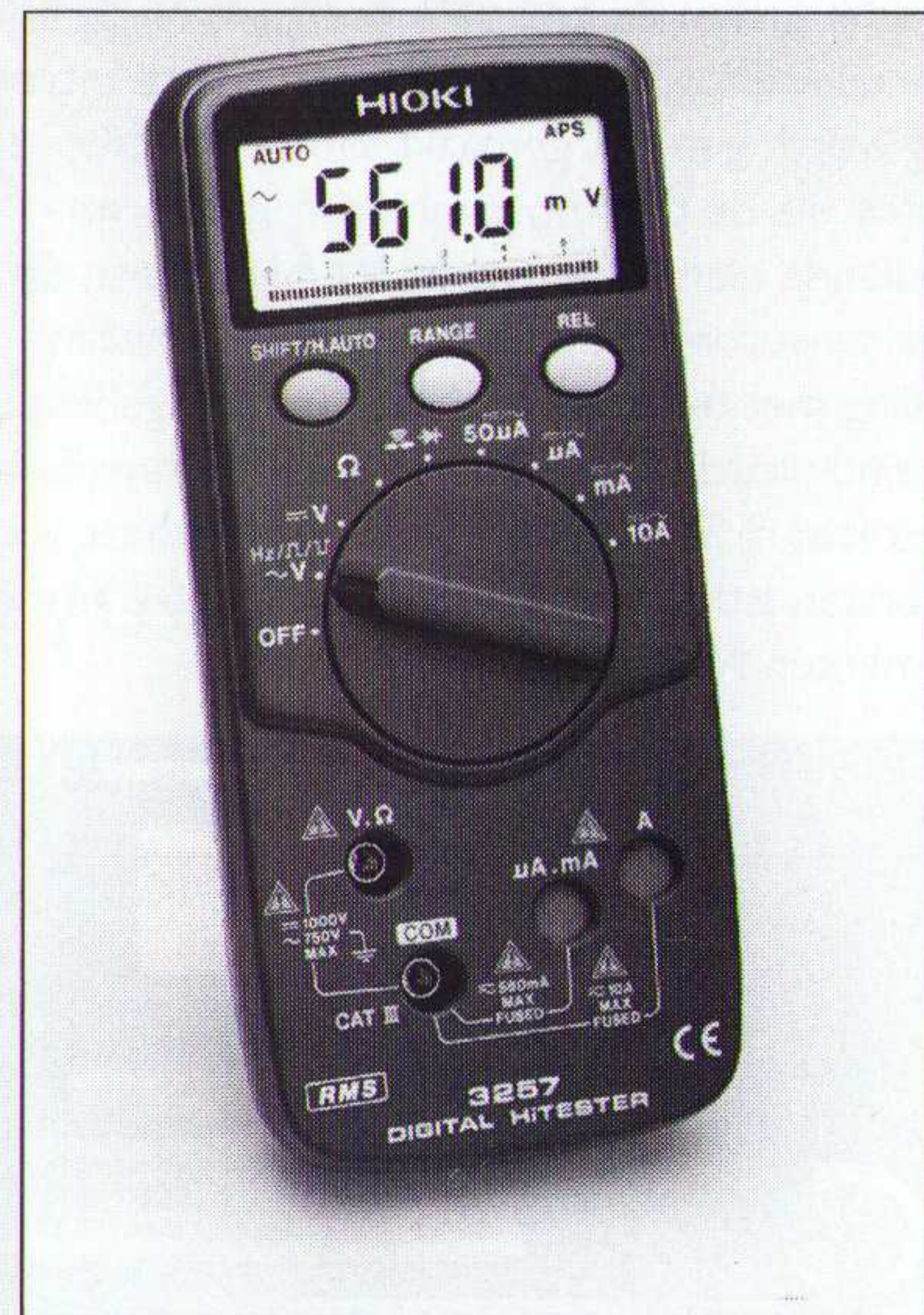
De H3257 digitale DMM met relatieve meting en echte RMS-waarde.
